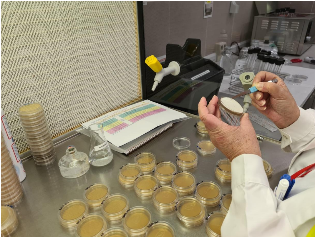
Colocación de la membrana en BEA tras su incubación en SB, en el método estándar lento
