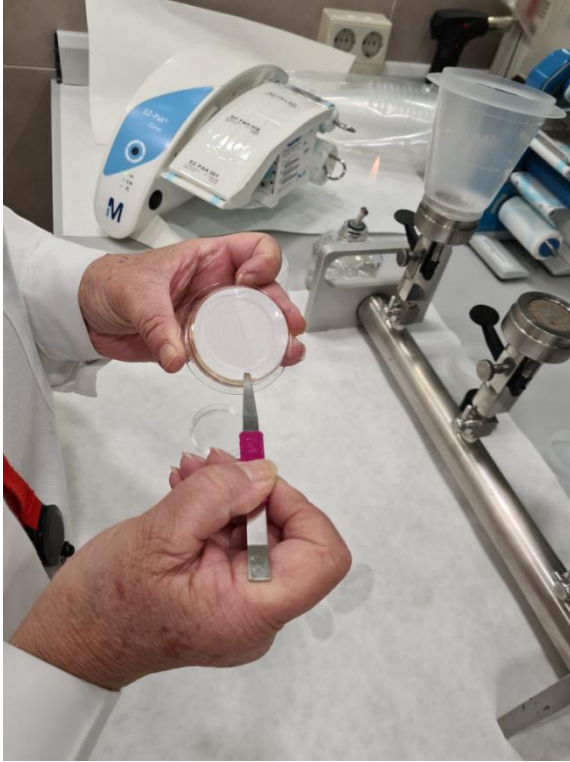
Colocación de las membranas filtradas sobre el medio de cultivo
